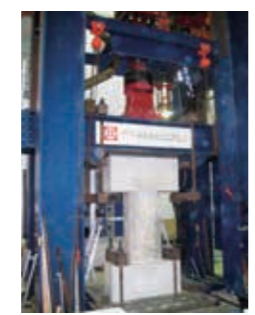
5 せん断破壊試験状況 建研式載荷装置
