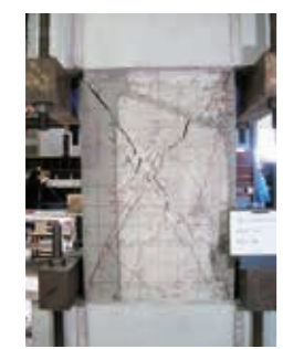
1 せん断破壊試験後状況(補修前) せん断破壊した柱状供試体 (AC-1)
