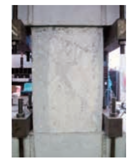
4 補修完了状況 注入完了後、表面研磨 (AC-1RE)
