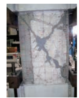
2 欠損部の修復状況 使用材料 IPH#600
